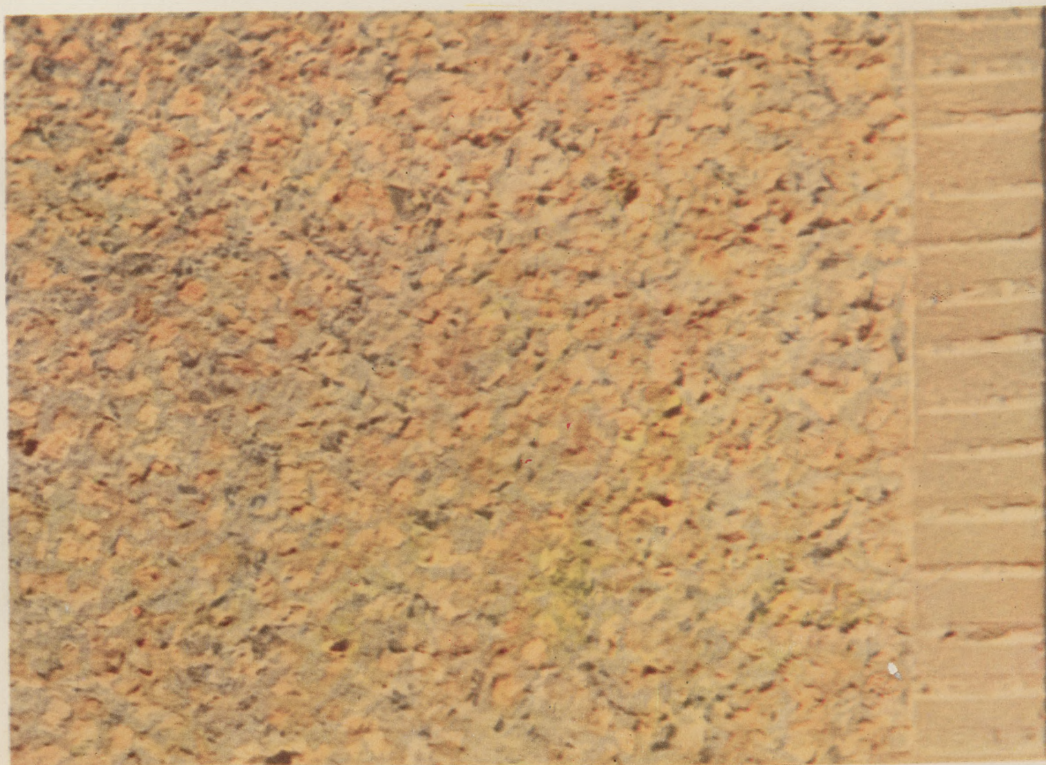
Tynk szlachetny, kamieniarski, młotkowany z dłutowanym obrzeżem, średnio- i gruboziarnisty
