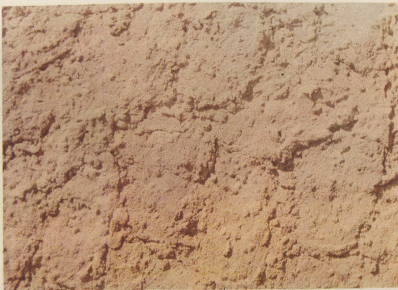
Tynk szlachetny (lub półszlachetny) narzucany kielnią, drobno-lub średnioziarnisty (zmniejszenie ok. 4-krotne)
